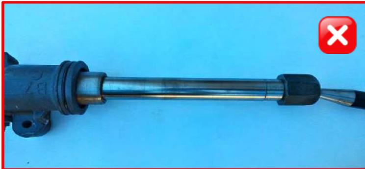
6. Folgend weitere Beispiele für nicht aufbereitungsfähige Lenkgetriebe.
