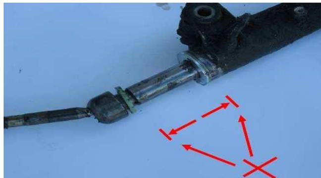
3. Das gesamte Lenkgetriebe muss vollständig intakt und unbeschädigt sein. Dies gilt insbesondere für Halterungen und die Anschlüsse der Hydraulikleitungen.
