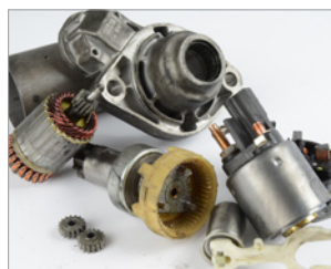
Das Aggregat ist unvollständig bzw. zerlegt in seine Einzelteile. Es fehlen Teile wie z. B. Regler, Riemenscheibe, Vakuumpumpe am Generator oder Anker, Magnetschalter, Wicklungen am Starter.
