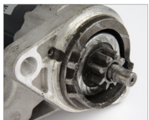
Das Befestigungsauge ist ausgeweitet/deformiert. Befestigungen sind abgebrochen. Antriebslagerschild des Starters gebrochen.
