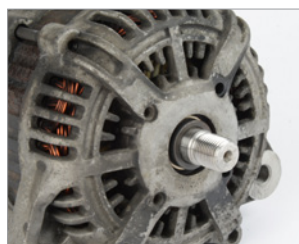
Das Aggregat ist mitgelaufen bzw. wurde überlastet und ist verbrannt. Die Merkmale hierfür sind: überhitzungsbedingte Verfärbung am Ritzel, Welle, Freilauf. Verbrannte Kabelverbindung zwischen Magnetschalter und Wicklung. Das Aggregat riecht verbrannt.
