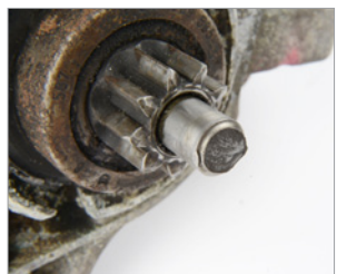
Die Rotorwelle bzw. das Gewinde stark beschädigt. Ankerwelle abgebrochen oder stark beschädigt.
