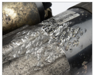
Die Rotorwelle bzw. das Gewinde stark beschädigt. Ankerwelle abgebrochen oder stark beschädigt.
