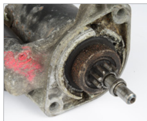
Das Aggregat ist stark korrodiert/oxidiert. Die Welle ist fest oder lässt sich schwer drehen.
