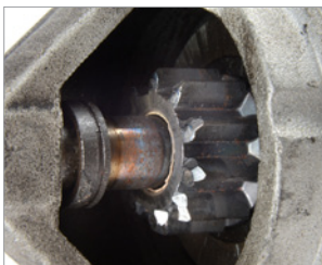
Das Aggregat ist mitgelaufen bzw. wurde überlastet und ist verbrannt. Die Merkmale hierfür sind: überhitzungsbedingte Verfärbung am Ritzel, Welle, Freilauf. Verbrannte Kabelverbindung zwischen Magnetschalter und Wicklung. Das Aggregat riecht verbrannt.
