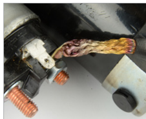
Das Aggregat ist mitgelaufen bzw. wurde überlastet und ist verbrannt. Die Merkmale hierfür sind: überhitzungsbedingte Verfärbung am Ritzel, Welle, Freilauf. Verbrannte Kabelverbindung zwischen Magnetschalter und Wicklung. Das Aggregat riecht verbrannt.
