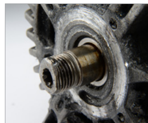
Die Rotorwelle bzw. das Gewinde stark beschädigt. Ankerwelle abgebrochen oder stark beschädigt.
