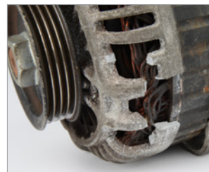
Das Aggregat ist mechanisch stark beschädigt bzw. das Gehäuse weist Risse auf.
