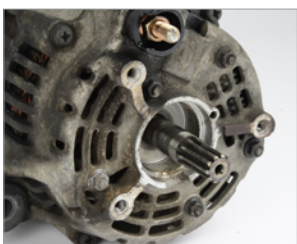
Das Aggregat ist mitgelaufen bzw. wurde überlastet und ist verbrannt. Die Merkmale hierfür sind: überhitzungsbedingte Verfärbung am Ritzel, Welle, Freilauf. Verbrannte Kabelverbindung zwischen Magnetschalter und Wicklung. Das Aggregat riecht verbrannt.
