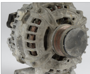
Das Aggregat ist stark korrodiert/oxidiert. Die Welle ist fest oder lässt sich schwer drehen.
