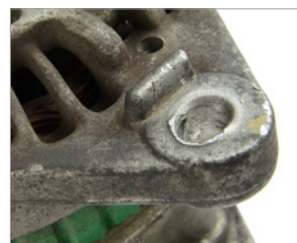
Das Befestigungsauge ist ausgeweitet/deformiert. Befestigungen sind abgebrochen. Antriebslagerschild des Starters gebrochen.
