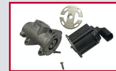
AGR-Ventil wurde zerlegt
