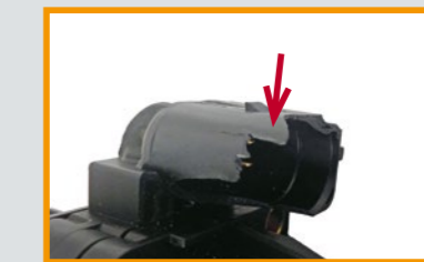
Kunststoffteile sind beschädigt
