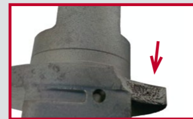
Gehäuse weist Bruchstellen auf
