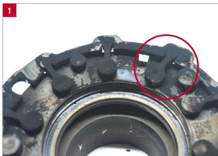
Rückseite der VTG mit Leitring und Hebel der VTG-Fahnen, der Ruß verhindert die Bewegung des Hebelwerkes
